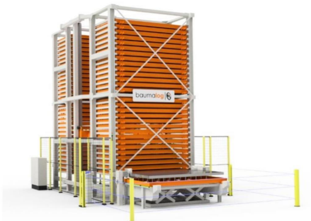
Rysunek 3 – Przykładowy regał automatyczny złożony z dwóch kolumn składowania (źródło: Baumalog)
