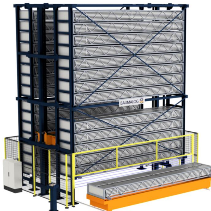
Rysunek 1 – Przykładowy regał automatyczny złożony z dwóch kolumn składowania (źródło: Baumalog)
